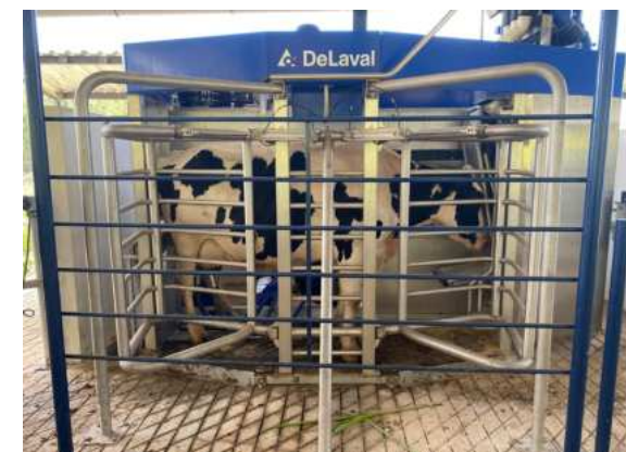
FIGURA 127: Sistema de ordenha robotizada na Fazenda Palmital
